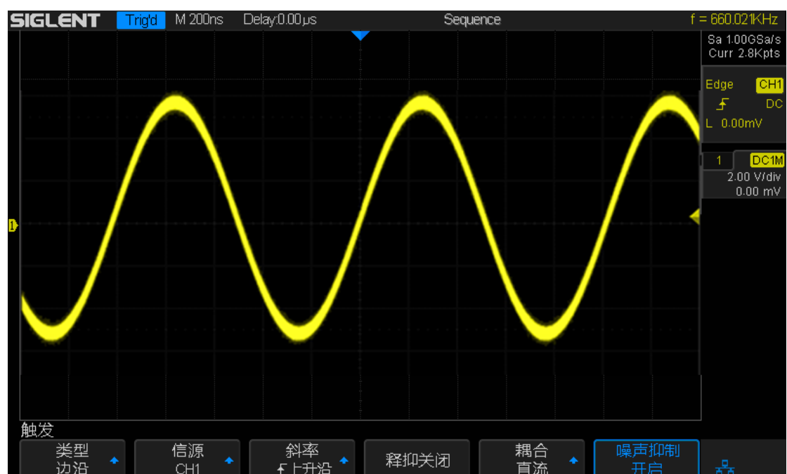
图 39 噪声抑制开启
