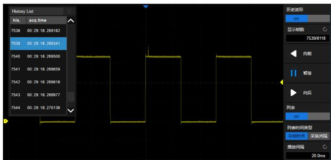
最大可记录 90,000 帧波形；自动实时录制，随时可回放历史波形观察异常事件，并通过光标或测量参数快速定位问题来源；面板上的“History”按键可以快速启动该功能
