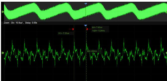
最大 200 Mpts/通道的深存储, 使用户能够使用更高的采样率捕获更长时间的信号, 然后快速放大需要关注的区域, 做到整体与细节的兼顾
