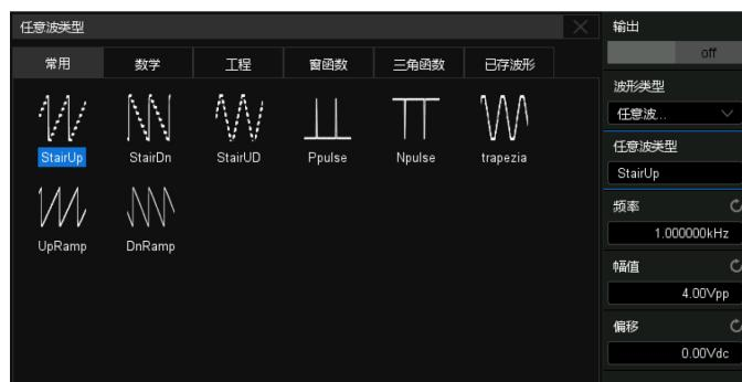
50 MHz 函数/任意波形发生器功能，集成了几十种常用内置波形，也可通过 EasyWave 上位机软件编辑任意波形并下载。用户可直接将示波器捕获的波形通过波形发生器还原
