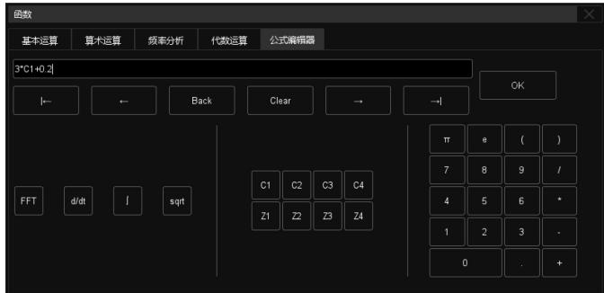
两条独立的 Math 波形，支持加法、减法、乘法、除法、FFT、微分、积分、平方根、平均和 ERES 运算，支持公式编辑器自定义运算表达式
