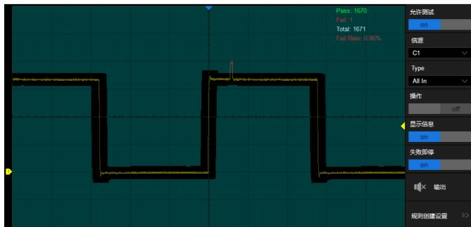
基于硬件的模板测试功能，最高每秒可执行 80,000 次测试。根据用户自定义的垂直和水平容限生成模板，比较被测信号是否触碰模板，如果被测信号触碰模板则测试失败，可以预先设定测试失败时采集停止以及蜂鸣器告警，将失败帧自动截图或存入历史帧，适用于长期无人值守监测异常信号
