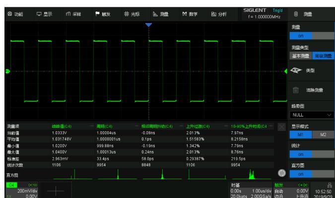
参数统计功能可显示任意参数的五种测量值：当前值、平均值、最小值、最大值、标准差；可同时测量统计 12 种不同的参数。直方图统计可以直观地显示参数的概率分布情况；趋势图可反应参数随时间的变化规律。
