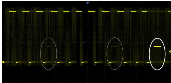
正常模式下 120,000 帧/秒, Sequence 模式下 500,000 帧/秒的波形刷新率, 使示波器能轻松捕获到低概率异常事件
