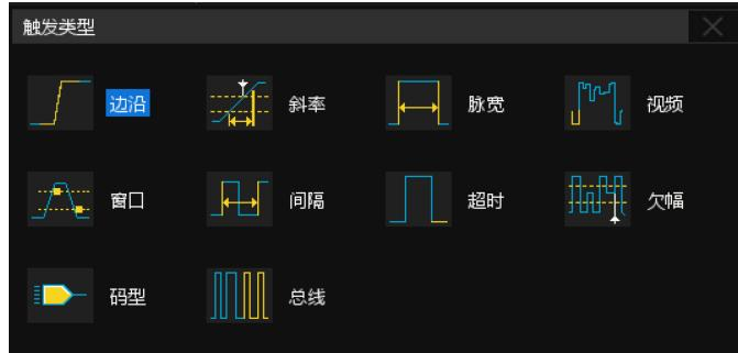
具有丰富的触发功能，包括边沿、斜率、脉宽、视频、窗口、间隔、超时、欠幅、码型和多种总线触发（即：串行触发）
