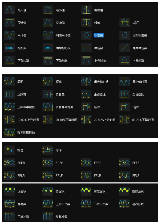
测量类型包括水平类、垂直类、通道间延时类和混合测量类共超过 50 种参数
