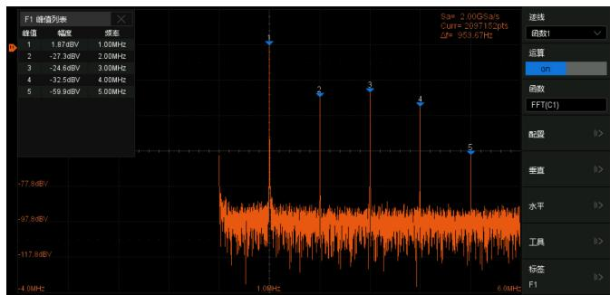
通过硬件加速的 FFT 功能，最大运算点数为 2M 点，在提供优越的频谱分辨率的同时，仍然能够保持较高的频谱刷新率。支持多种窗函数，支持普通、平均、最大值保持等模式，支持自动标记峰值点
