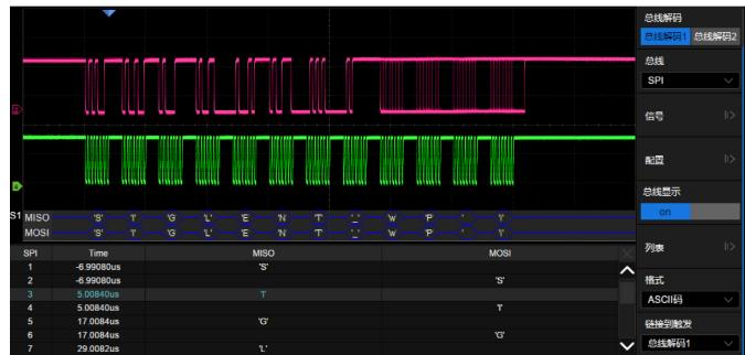
通过事件列表显示解码，能快速、直观地将总线的协议信息以表格形式显示。支持 I2C, SPI, UART, CAN, LIN, CAN FD, FlexRay, I2S 和 MIL-STD-1553B 等多种协议
