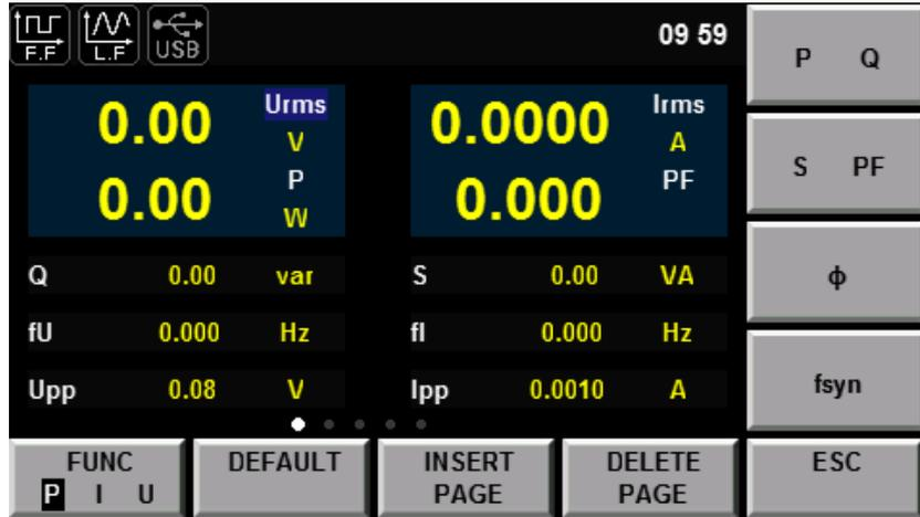
3. 按“FUNC”對應的軟鍵，選擇測量功能。例如每按一次“FUNC”，顯示的測量功能會按照 P/I/U 順序切換一次。不同的功能顯示不同的測量參數。本操作以測量功率為例，所以選擇 P。
