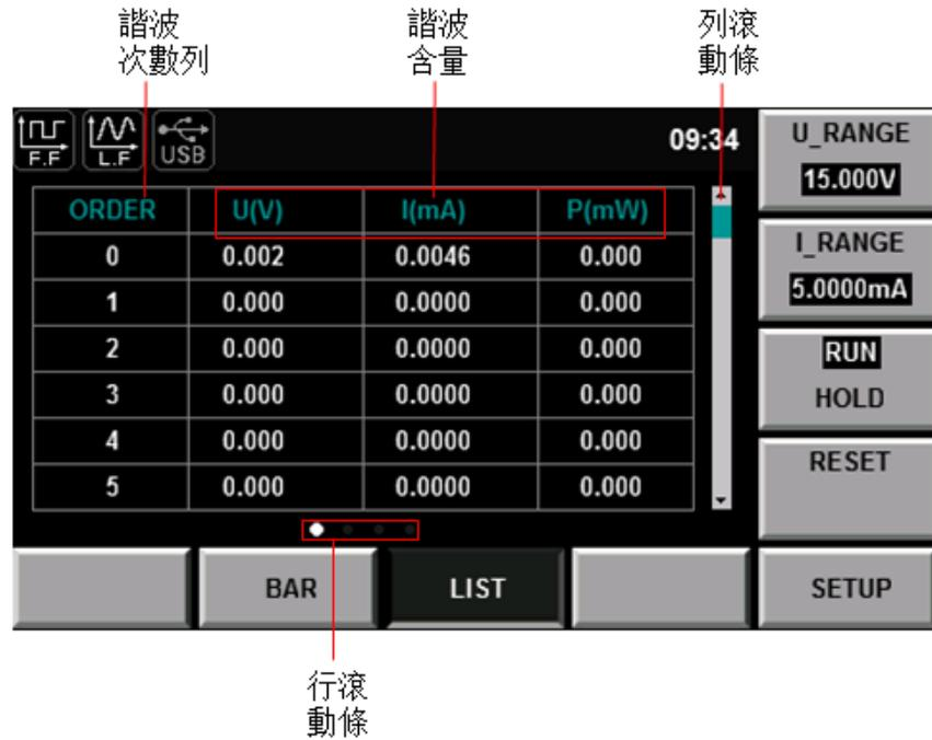
諧波含量：該清單可顯示單次諧波的所有諧波含量，包括電壓、電流和功率。您可以通過左右鍵翻頁查看其他諧波參數。此時行捲軸，當前頁面呈高亮度白色圓圈顯示，測量參數說明如下表所示：
