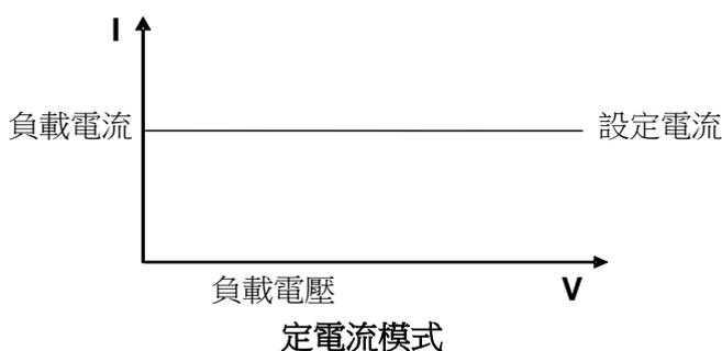
圖 3-1 CC 模式電壓電流關係圖
