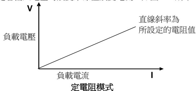
圖 3-3 CR 模式電壓電流關係圖
