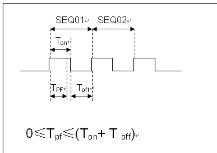
$T_{pf}$  為測試延時時間
