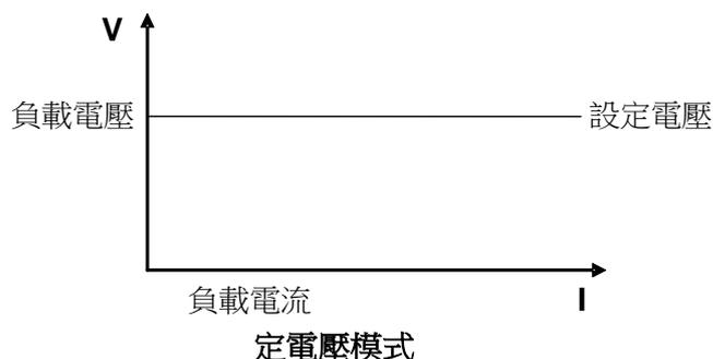
圖 3-2 CV 模式電壓電流圖
