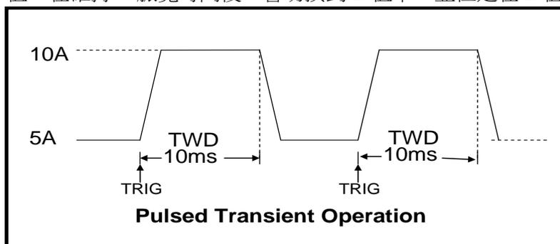
以 CC 模式為例（其他模式操作類似），當被测儀器輸出電壓為 10V，電流 3A，負載電流在 1A 和 2A 之間切換，設定動態測試參數和執行動態測試的步驟如下：
