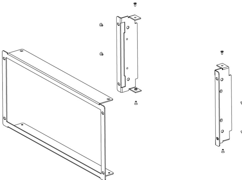
步驟3、將拆卸後的支架左右板安裝到機框上。
