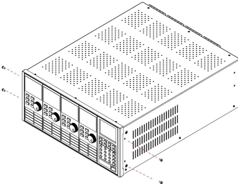
步驟2、將IT-E153B左右兩側支架板及所有螺絲卸下。如下圖所示。
