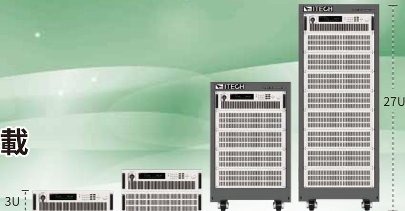
ITECH最新推出的IT8300系列能量回饋式直流電子負載既能模擬各種負載特性，又能將電能無污染的回饋電網。其獨特的能量回收功能可將吸收的直流電轉化成工頻交流電，然後返回給電網，不但為用戶節省了用電和散熱成本，同時也符合節能環保的需求。採用高功率密度設計，3U體積內可提供高達10.5kW的功率吸收，通過主從並聯和均流功能，可將功率擴展至105kW或以上。IT8300系列可以自動檢測電網狀態、累計並網電量、提供孤島保護功能、電池測試功能、動態帶載模式以及LIST功能。內置LAN/USB/RS232/RS485/CAN通信介面，特別適用於大功率電源、蓄電池、光伏電池、電動汽車、儲能系統等測試領域。
