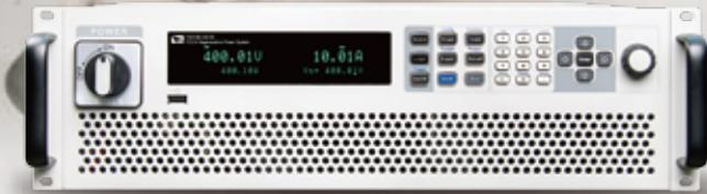
ITECH從提升用戶體驗的角度出發，推出了一機兩用的全新產品——IT6000B系列，很好的將雙向電源和回饋負載集成到了僅3U體積的一台儀器內，也是功能非常強大的一款產品。一個按鍵就可以讓它在雙向電源和回饋負載中間自由切換，不僅可以作為一台獨立的功能強大的雙向電源使用，實現source的功能，提供功率；也可以作為一台獨立的回饋負載使用，不但可以吸收功率還能將消耗的能量清潔的返回至電網，具有標準的雙象限功能。
